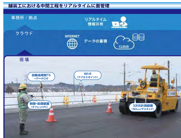
建機搭載型出来形管理システムイメージ
