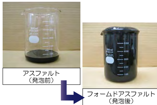
-ecole に使用するフォームドアスファルトの発泡状況-
