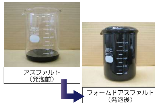
-ecole に使用するフォームアスファルトの発泡状況-
