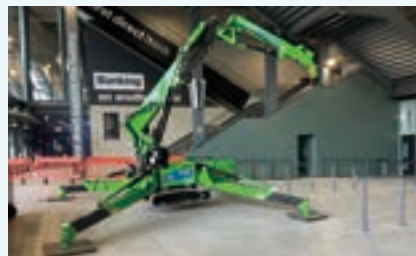
MK3053CB (バッテリー搭載ナックルブームクレーン)
