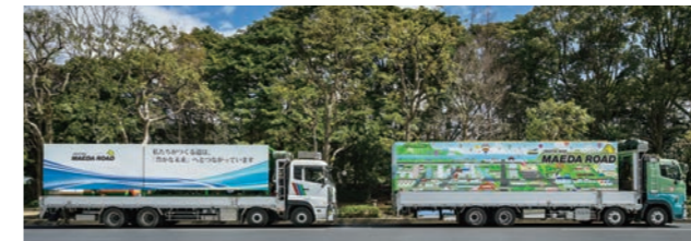
② 簡易設置型・強化路盤混合プラント運搬状況
