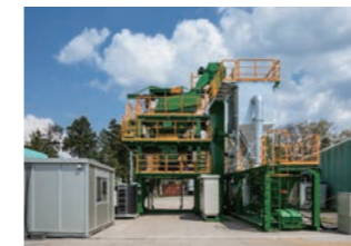
① 簡易設置型・アスファルトプラント
