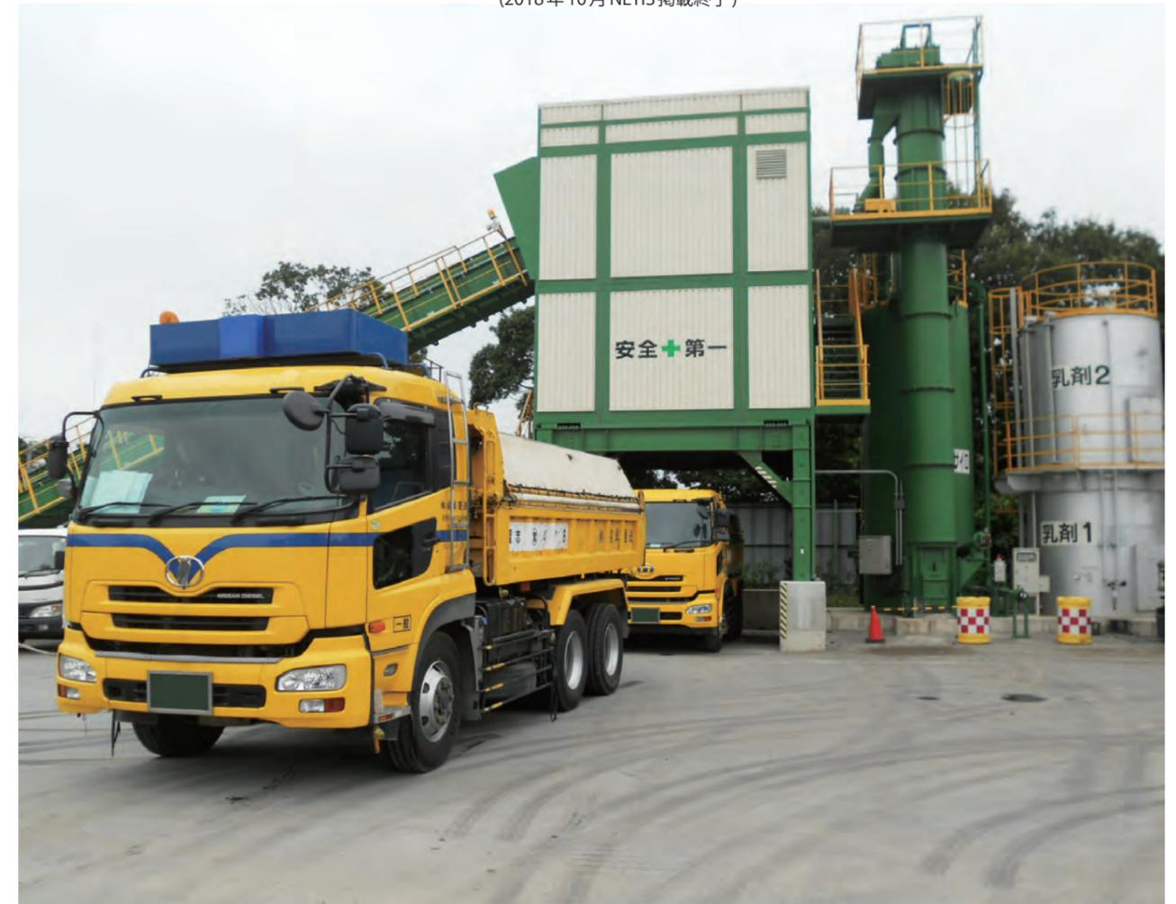
「マイルドベース」は、再生路盤材をアスファルト乳剤およびセメントで固めた、たわみ性と剛性を持つ耐久性に優れたセメントアスファルト乳剤安定処理路盤材 (CAE) です。製造は工場で行い、ダンプトラックで運搬し、通常の路盤材と同様に施工することができます。
