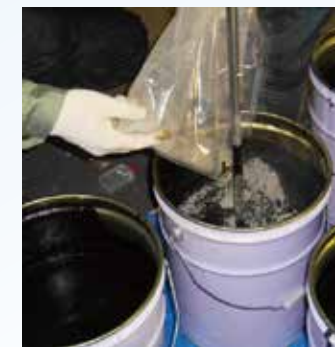
砂・石粉、硬化材の添加・混合
