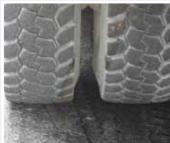
▲ノンスティックゾルの状況 (タイヤへの付着なし)
