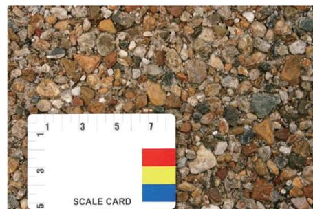
骨材が露出した状態 (施工後約 2 年)
