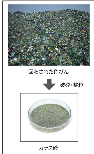
廃ガラスびんの破碎・整粒
