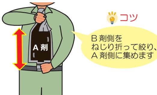
B 剤側をねじり折って持ち、上下に **20** 回程度振って混合します。
